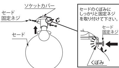
**△ ネジを固定した後に再度、セードがしっかりと固定
