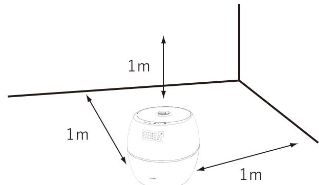
水平な場所で、壁・家具・家電製品から1m以上離れた場所に設置してください。
