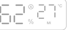
タンクの水がなくなるとディスプレイの表示が点滅して電源が切れます。
